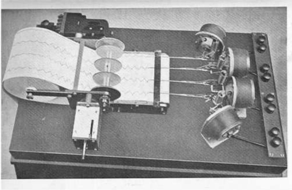
**Strumento:** Chimografo (poligrafo) con quattro complessi registratori
